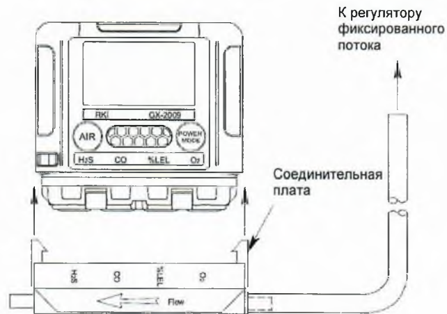
Рис.12. Установка соединительной платы, режим One Cal
